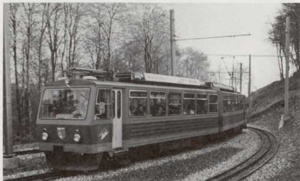
Der Bhe 4/8 11, der als einziger der vier Doppeltriebwagen über zwei Pantographen verfügt.
