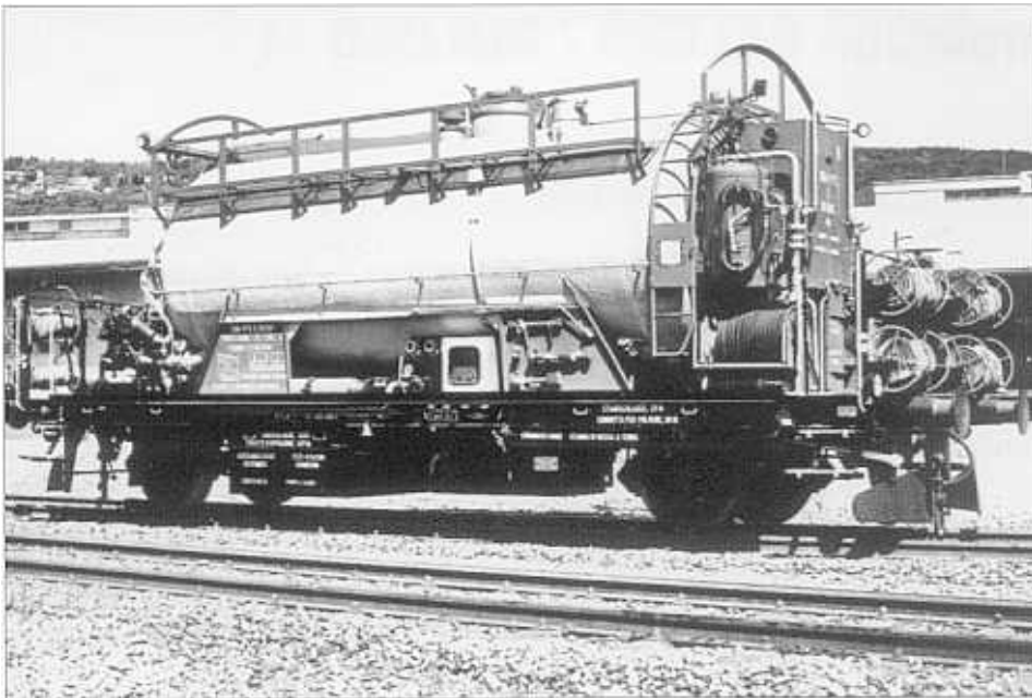
Tanklöschwagen des Tunnelrettungszuges Göschenen (Prototyp der LRZ) vor dem Umbau von 1985 (Ursprungszustand) (1964). (Foto: SBB)
