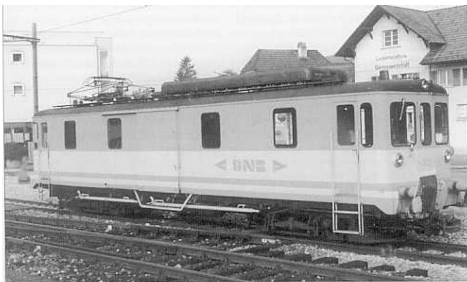
Der mit Normalspurruffern ausgerüstete De 4/4 321 in Niederbipp (19.8.98; Foto: M. Klausner).
