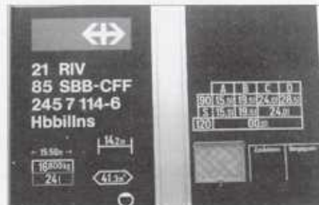
Foto 4: Hbbilss: Schiebewardwagen der neuesten Generation. Unbeladen kann dieser Wagen in Zügen bis 120km/h mitgeführt werden (Freienbach, April 91)
