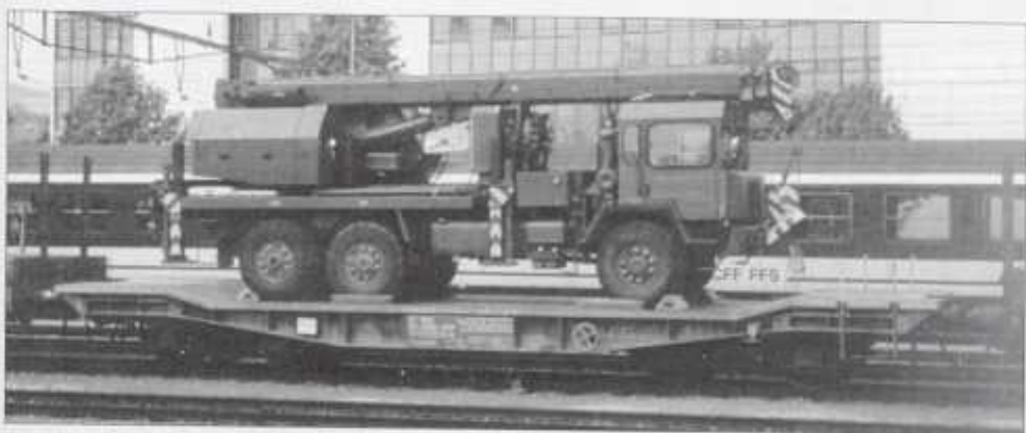
Kranwagen verladen auf einem Smmmp (Thun, 16.5.98, Foto P. Hürzeler)
