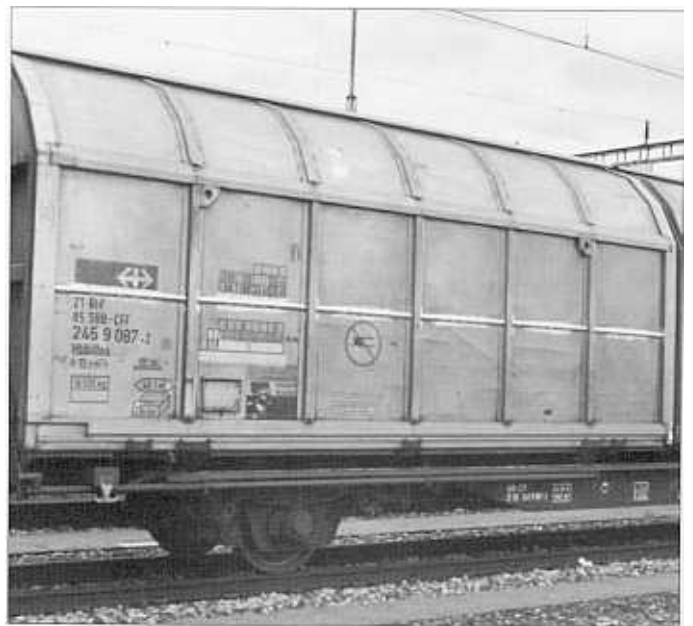
Hbbillns 21 85 245 9 087-2 im RB Limmattal. Gut sichtbar sind die zur Verstärkung angeschweissten L-Profile (17.5.2003; Foto: P. Hürzeler).
