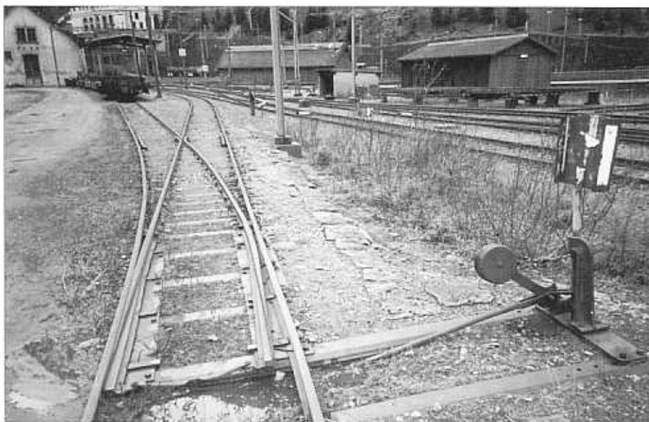
einfacher Weichenantrieb ohne Verschluss, Göschenen FO (Foto: H. Berneth).
