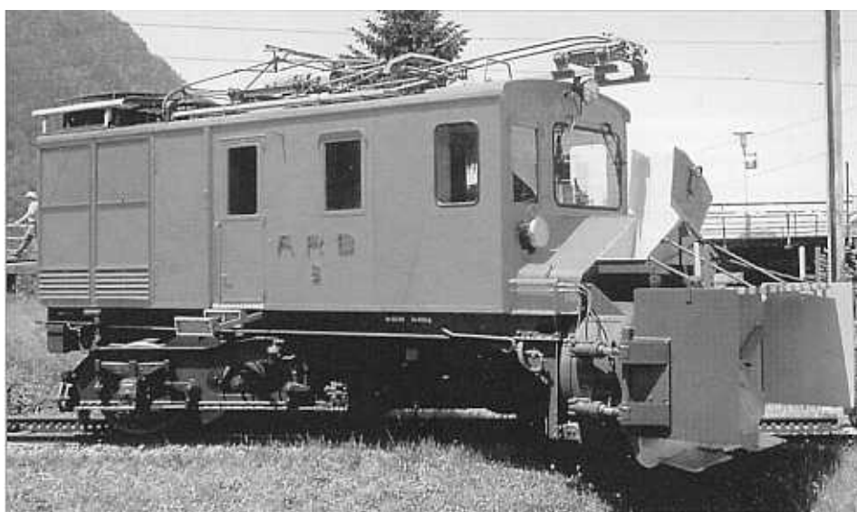
Die aus den zwanziger Jahren stammende Schneeschleuderlok He 2/3 8 demonstriert ihren Drehmechanismus. (Arth-Goldau, 4.6.00; Foto: A. Hügli)
