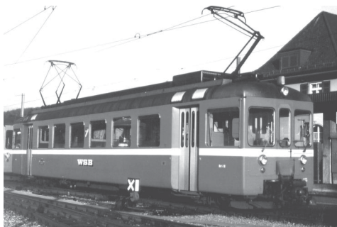
Typenbild des Be 4/4 13. Seit 1989 verkehrt er der besseren Stromaufnahme wegen mit zwei (unterschiedlichen) Stromabnehmern. (Foto M. Emmenegger)
