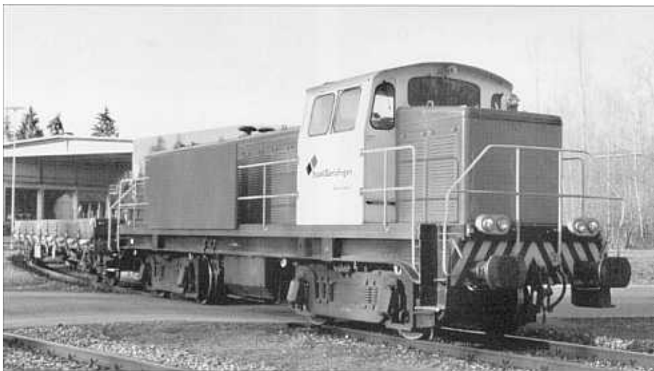
040-DE der Stahl Gerlafingen beim Rangieren. Gut sichtbar ist das im Text erwähnte Schallschutzblech (20.2.2004; P. Hürzeler)
