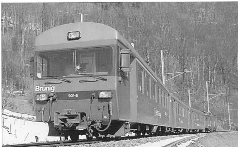
Typischer Tal-Pendelzug mit ABt 901, 2 B und einem De 4/4 (Foto: A. Sigron).
