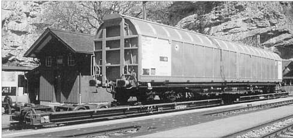
An Ostern gelang erstmals ein Habbins der neusten Generation, verladen auf den Rollschemel Ua 9829 und 9831 nach Brienzwiler (22.4.00; Foto: P. Hürzeler)
