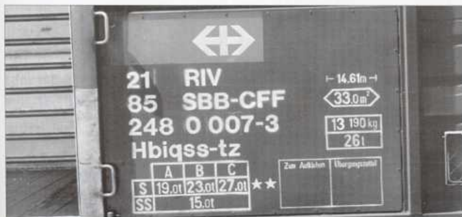
Stirnseite eines Hbiqss-tz mit den im Text erwähnte Besonderheiten (Juli 95, Rheinfelden, Foto E.Maniz)
