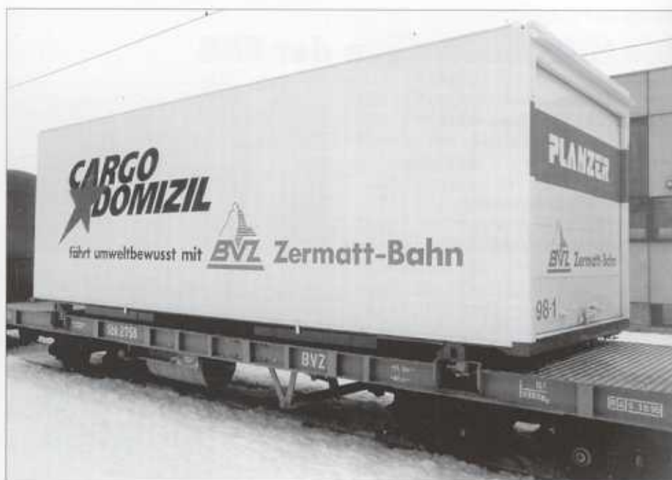
Containerwagen der BVZ für den Transport des Cargo-Domizils (Foto: BVZ)
