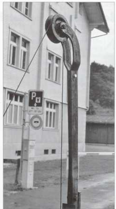
Details immer wieder: eine Umlenkrolle beim Vorbild.
