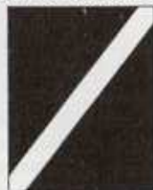
Anfangssignal einer Langsamfahrstrecke
