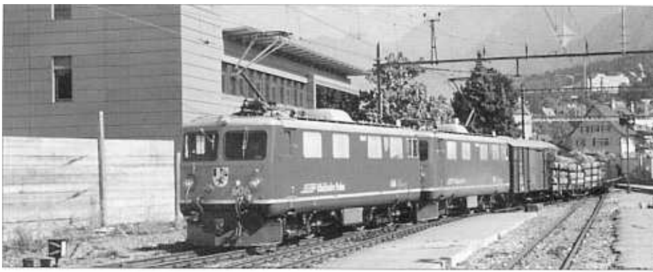
Zwei Ge 4/4 I in Vielfachsteuerung in Chur (13.9.2002; Foto: S. Sigrüst)
