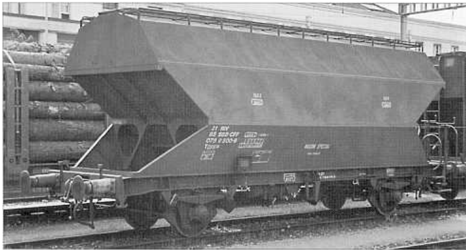
Der Tgpps 21 85 078 9 500-9 der modernisierten Anschlussserie (Zofingen, 22.05.01; Foto: P. Kaderli).
