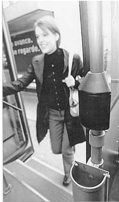
Die Antennen zur Kartenerfassung können in Haltestangen untergebracht werden (Foto: SBB)
