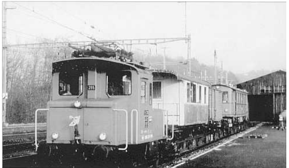
Rangiertraktor Tem II der SBB manövriert in Roggwil-Wynau (BE) die Spezialwagen Uaikk mit BA-Personenwagen C 12, FW-Güterwagen K 25 und FW-Triebwagen BCe 2/4 1, drei Museumsfahrzeuge des Vereins FSS (Foto: R. Steiner).
