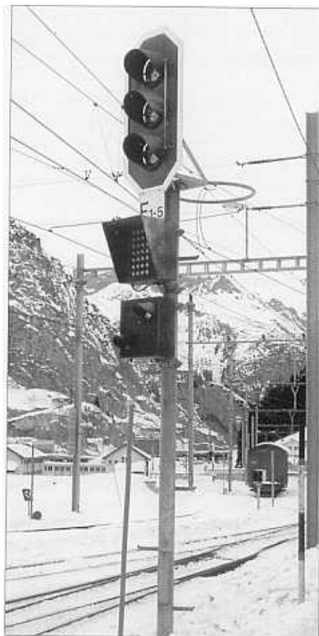
Hauptsignal mit 3 Lichtern (grün, rot, brandgelb) + Gleisnummeranzeiger + Abfahrtsignal. Ausfahrtsignal E1-5. (Andermatt Dezember 1998)
